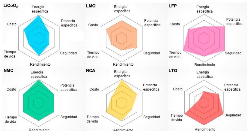
Figura 3.7: Comparación entre las distintas químicas de celda utilizadas en vehículos eléctricos según energía específica, potencia específica, seguridad, rendimiento, tiempo de vida y costo [6].
