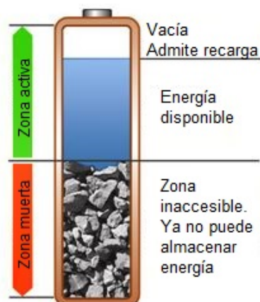
Figura 6.1: Efecto de pérdida de capacidad en baterías.
