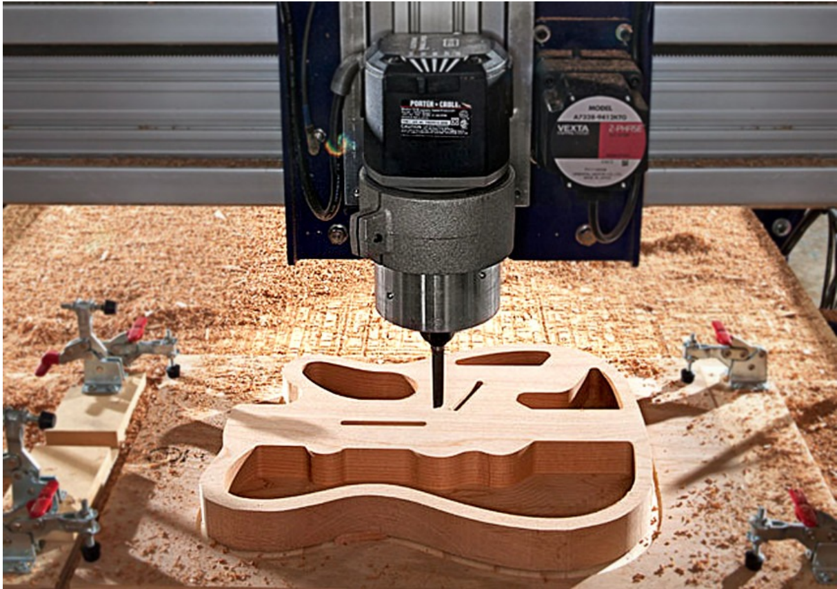
7. EJEMPLO DE FRESADO 2D. (MESA CON MÉTODO DE SUJECIÓN POR BRIDAS)
