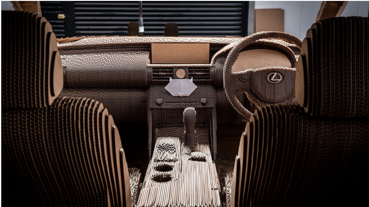
26. AUTO LEXUS ESCALA 1:1 REALIZADO POR CORTE LÁSER EN CARTÓN CORRUGADO.
