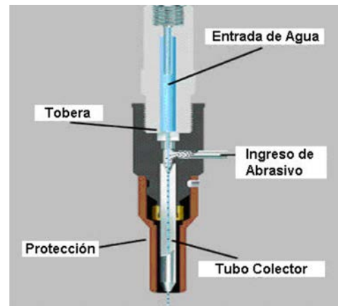
49. ESQUEMA DE BOQUILLA CON ABRASIVO
