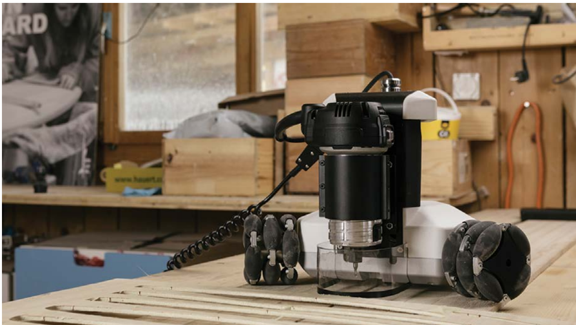
15. GOLIATH CNC - ROBOT CNC SIN LIMITE DE TAMAÑO DE MATERIAL.
