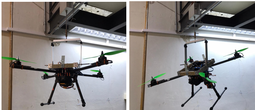
Figura 15.2: Drone montado en el dispositivo de pruebas del control de actitud.
