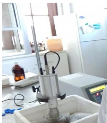
**Figura 10:** Ultrasonido utilizado en el laboratorio equipo SONICS®, modelo Vibra Cell Processors VCX 500/VCX 750.
