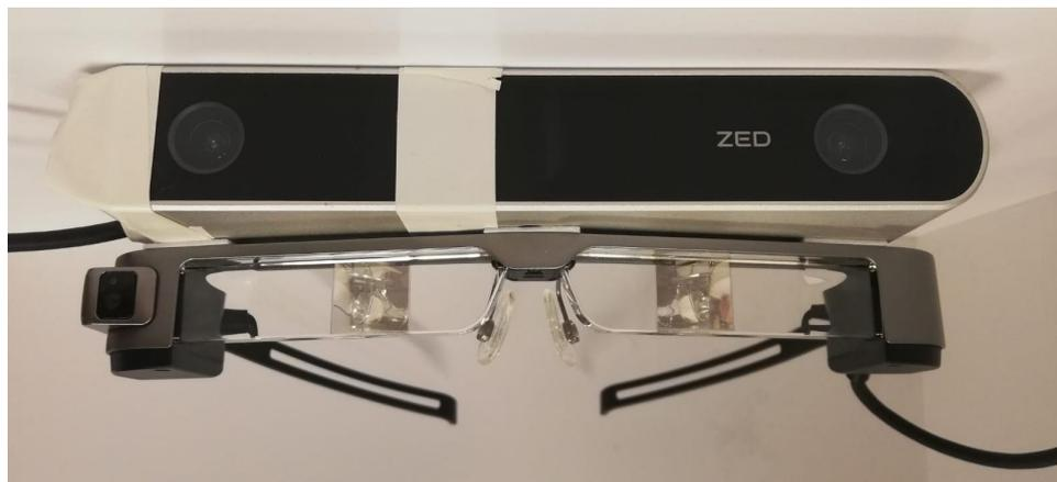
Figura 4.8: Montaje del sensor ZED sobre los Moverio BT-300.
