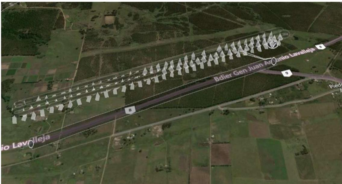
Captura de pantalla del programa eMotion del plan de vuelo de una de las misiones con el dron eBee classic. Se observan la trayectoria seguida con las imágenes tomadas.
