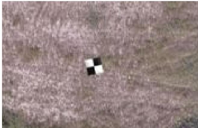
Figura N°6: Ejemplo de puntos de control del tipo personalizados, para vuelo Dron.
