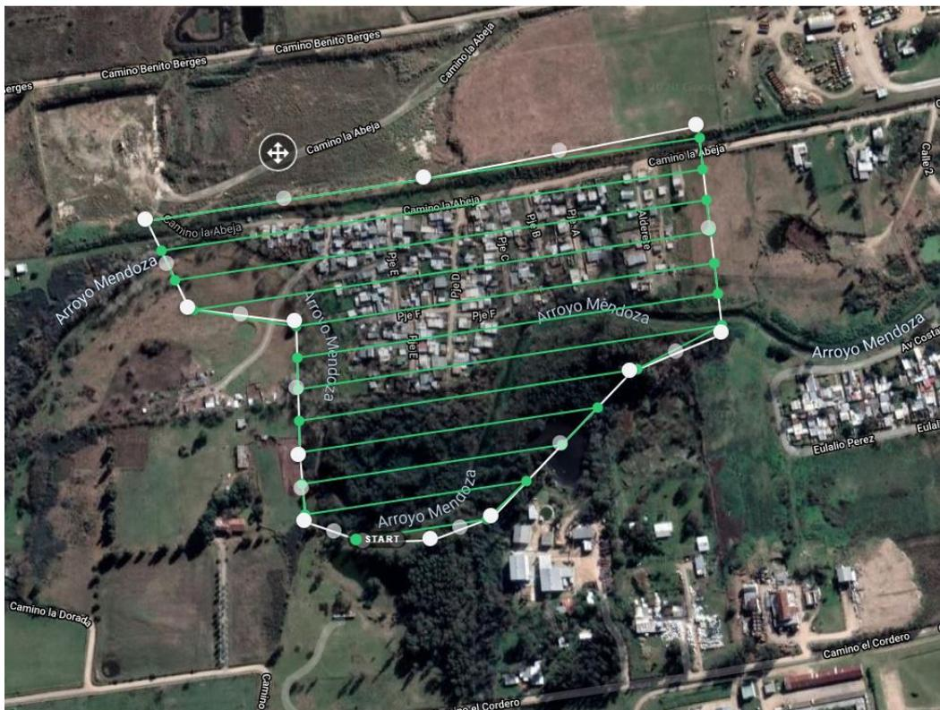
Figura N°5: Planificación de vuelo generada para ejemplificar. Delimitación del perímetro.
