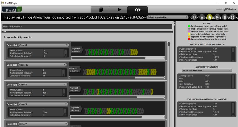
Figura 4.8: Salida obtenida de aplicar *conformance checking* de una *Petri net* contra un log.
