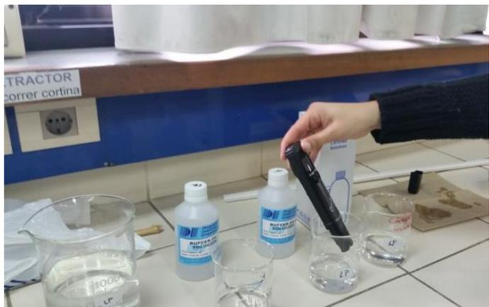
**Figura 2** – A y B Calibración del equipo de medición de pH, temperatura y conductividad eléctrica.
