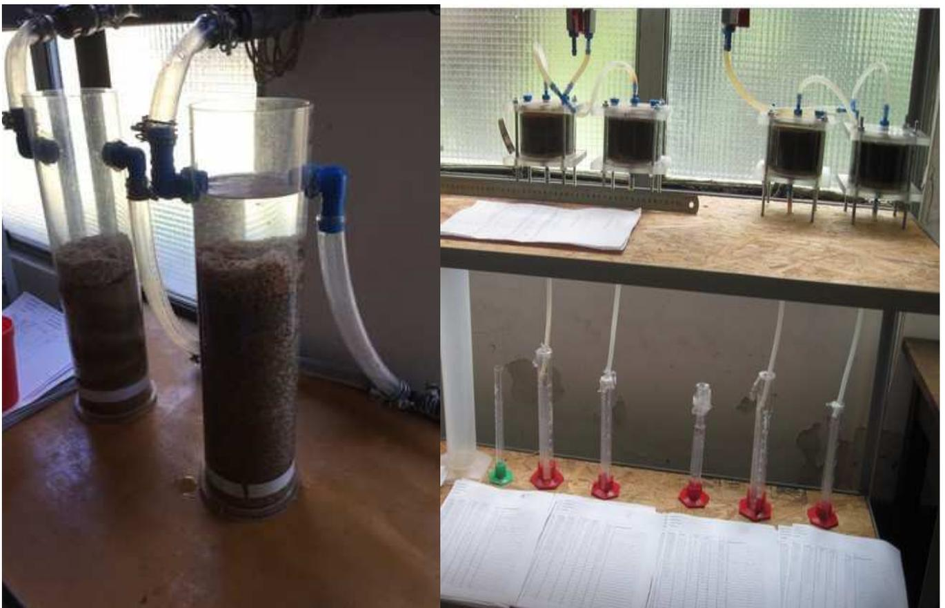
**Figura 10:** Ensayos de conductividad hidráulica para sedimentos gruesos (izquierda) y para sedimentos finos (derecha).
