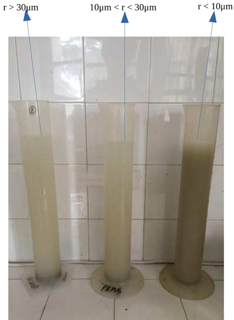
**Figura 9:** Vista de ensayo de la separación de la fracción limo (entre 10 y 30 micrómetros de diámetro)
