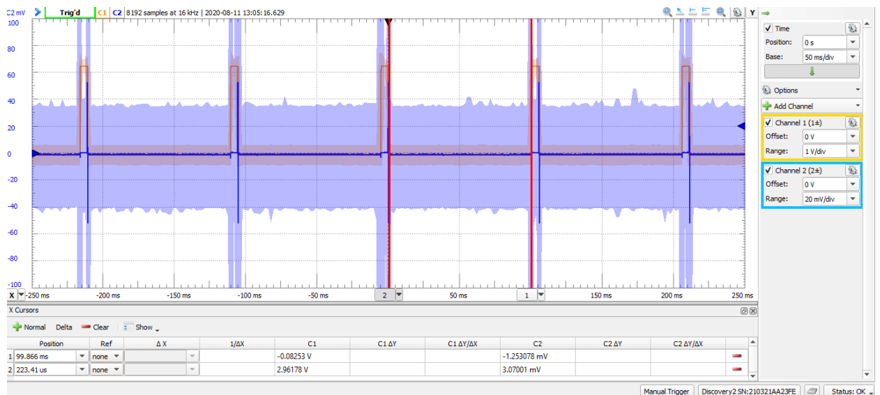
Figura 8.4: Tren de pulsos con distancia de 100ms interpulso.
