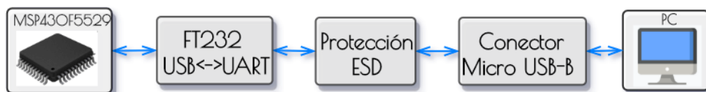
Figura 3.7: Diagrama de electrónica del bloque de comunicación.
