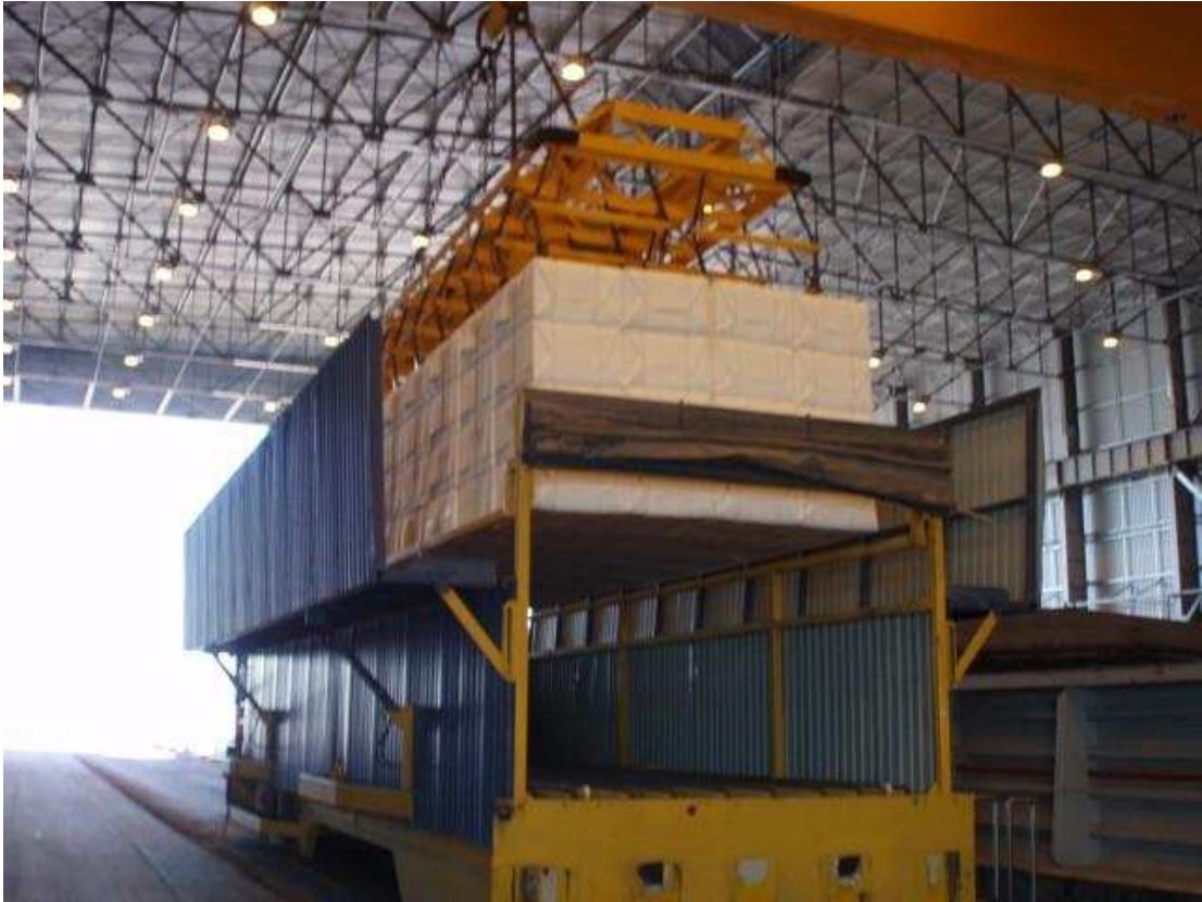
Ilustración 34: Grúa pórtico cargando celulosa en la barcaza.
