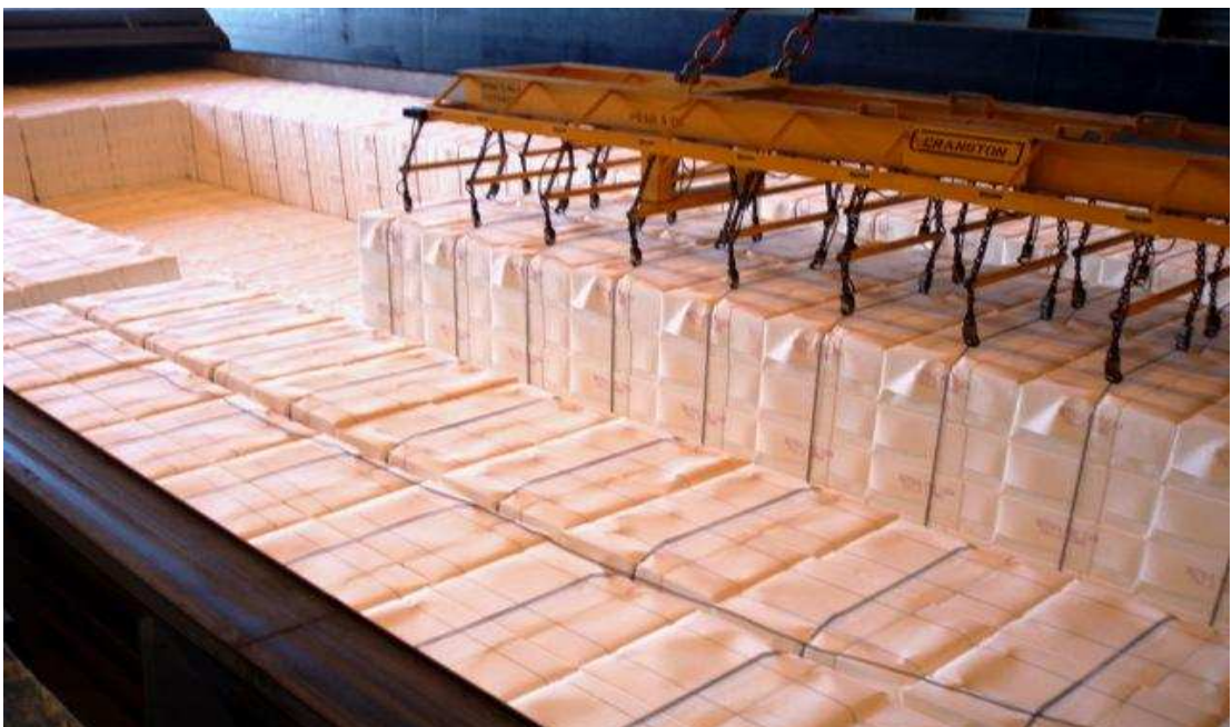
Ilustración 36: Grúa pórtico cargando celulosa en la barcaza.
