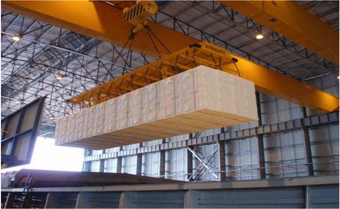
Ilustración 35: Grúa pórtico cargando celulosa en la barcaza.
