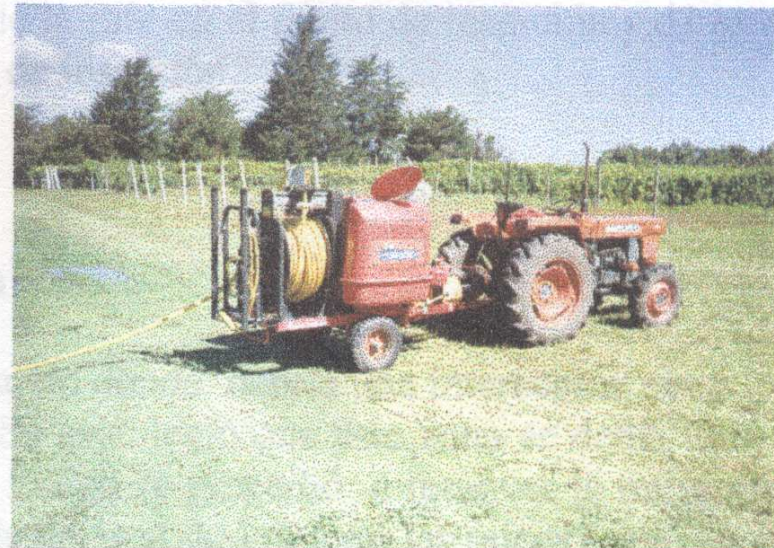
Figura N° 12: Equipo utilizado para generar el chorro de agua a presión
