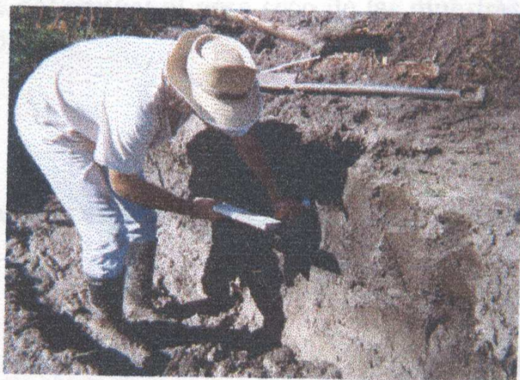
Figura N° 18: extracción de las muestras en el perfil de suelo
