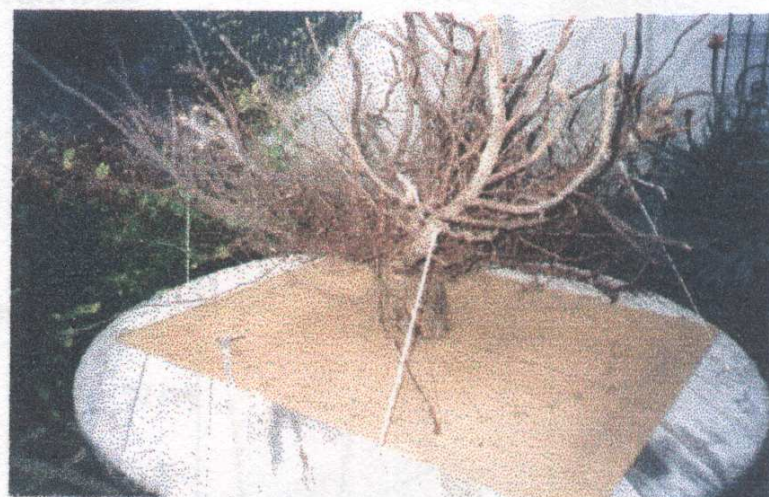
Figura N° 14: Dispositivo utilizado para medir los ángulos de las raíces
