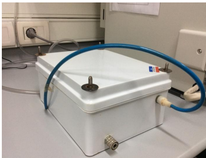
Figura 36 Fotografía cámara de trigas.
