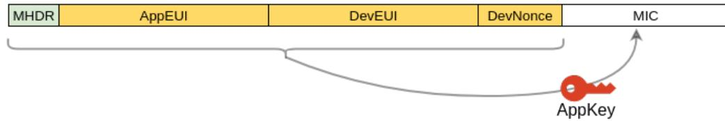
Figura 2.10: Formato de un mensaje de JOIN Request.
