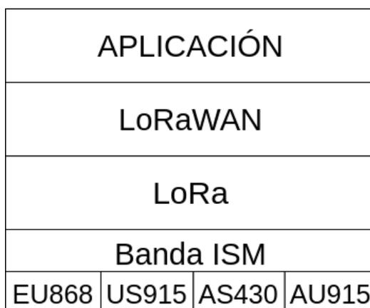
Figura 2.2: Diagrama de capas de comunicación implementadas por un dispositivo.
