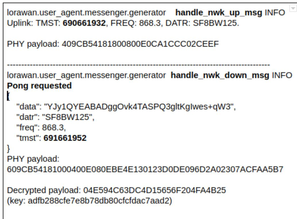
Figura 5.14: Información mostrada por el Message Inspector donde se observa que el mensaje de downlink está agendado 20 microsegundos más tarde del inicio de la ventana de Downlink RX1.
