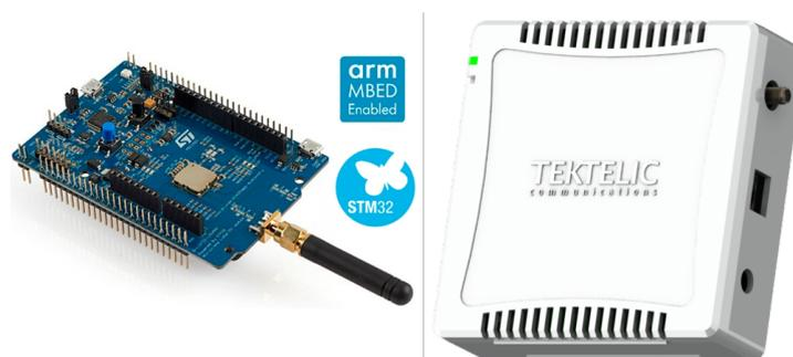
Figura 5.6: ST Discovery Kit B-L072Z y Gateway Tektelic Kona Micro, dispositivos utilizados para probar la plataforma de tests de conformidad LoRaWAN.
