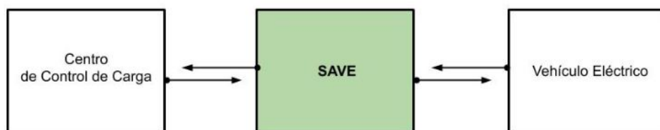
Figura 2.1: Esquema representando la comunicación entre el SAVE y el resto del sistema.
