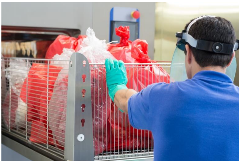
FIGURA 13: Imagen de la Estación Cisa (Italia) de Tratamiento de Residuos Hospitalarios (ETR). La ETR Cisa esteriliza y tritura residuos contaminados transformándolos en residuos comunes. Extraída de CISA GROUP. (2018)
