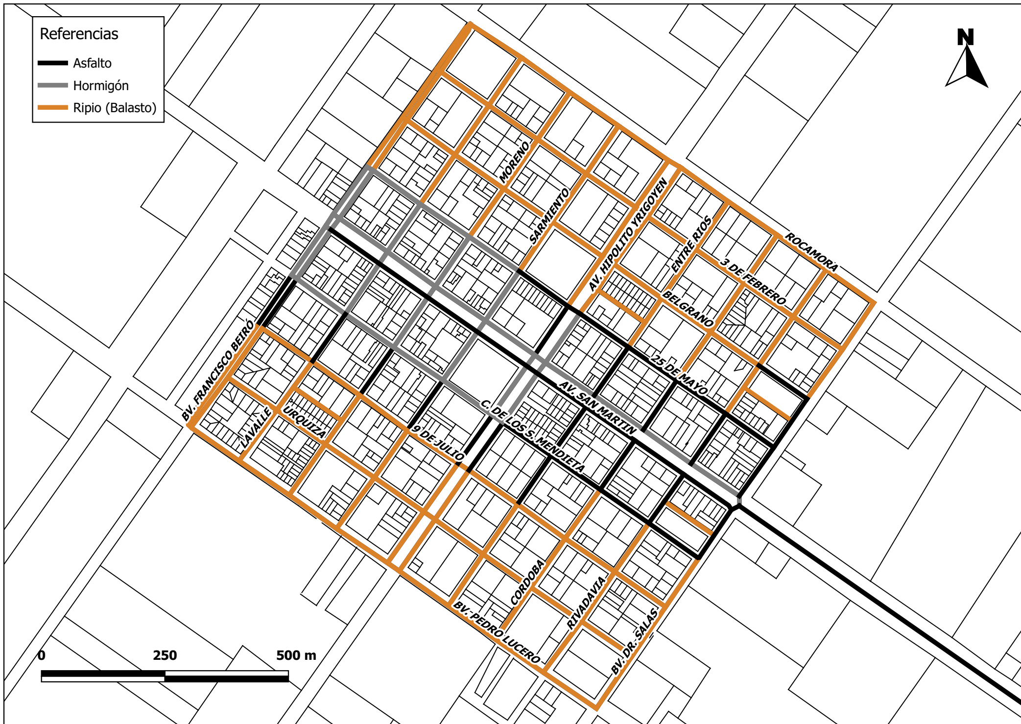
Figura 4 : Situación actual de las calles de la localidad
