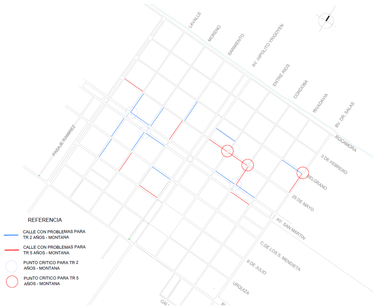
Figura 33 : Identificación de puntos críticos aplicando Montana - Tr de 2 y 5 años
