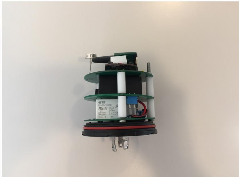
Figura 4.25: Foto del controlador de costado sin tapa, en la cual se aprecian los contactos de la base compatible ANSIC136.41.
