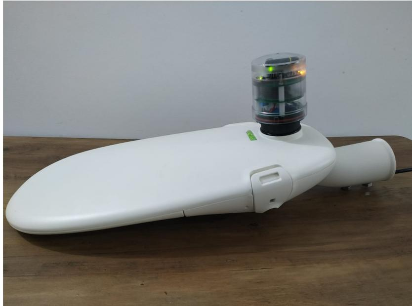
Figura 4.28: Foto del controlador conectado a la luminaria Taurus-36, de costado.
