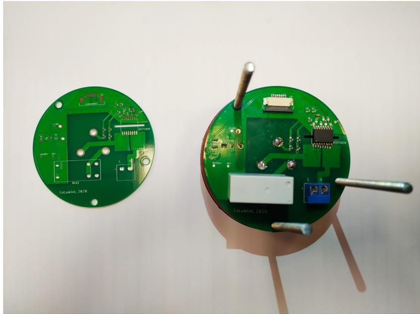
Figura 4.20: Fotos de placa inferior. La de la izquierda no tiene componentes soldados; la de la derecha tiene los componentes soldados y se encuentra acoplada a la base del controlador.
