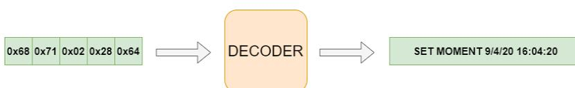
Figura 6.3: Ejemplo de prueba de la decodificación hecha por el módulo decoder.
