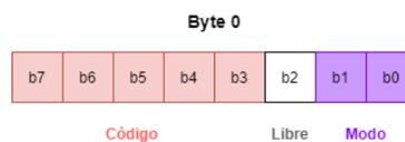
Figura 5.11: Diagrama del comando SET MODE codificado.
