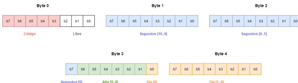
Figura 5.12: Diagrama de la organización de los bits en el comando SET MOMENT.
