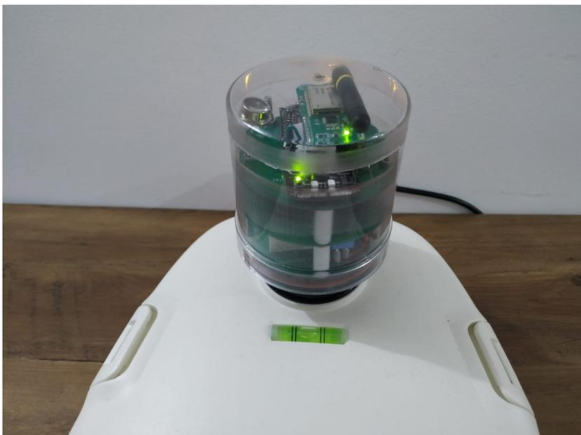
Figura 4.27: Foto del controlador conectado a la luminaria Taurus-36, de cerca.
