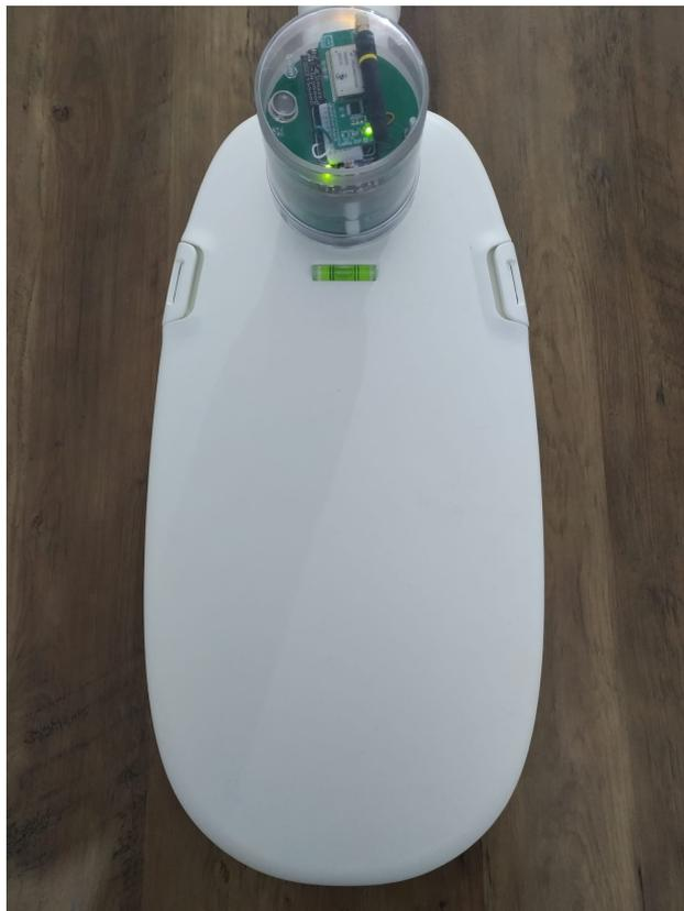
Figura 4.29: Foto del controlador conectado a la luminaria Taurus-36, desde arriba.
