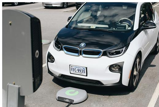
Figura 2.6: Vehículo BMW i3 en estación de carga PLUGLESS (Fuente: [53]).
