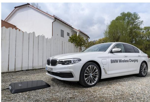
Figura 2.7: BMW 530e iPerformance con sistema de CII BMW Wireless Charging (Fuente: [51]).
