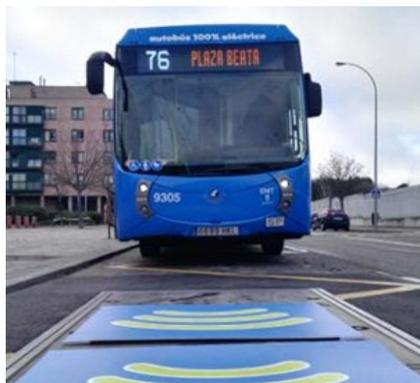
Figura 2.5: Autobús en estación de carga (Fuente: [45]).
