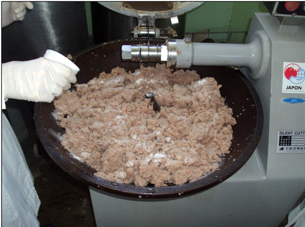
**Figura 22:** Agregado de sal en silent Cutter Naganuma NHY-12.
