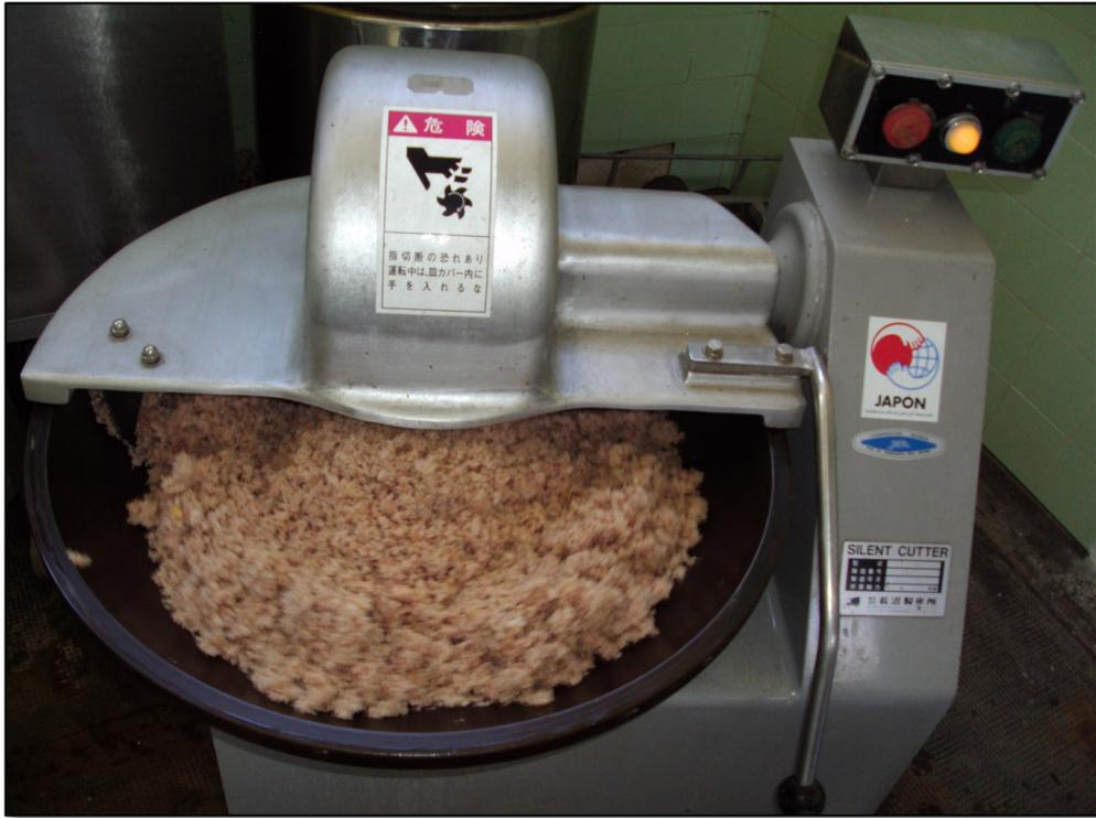
**Figura 21:** Silent Cutter Naganuma NHY-12 en funcionamiento.
