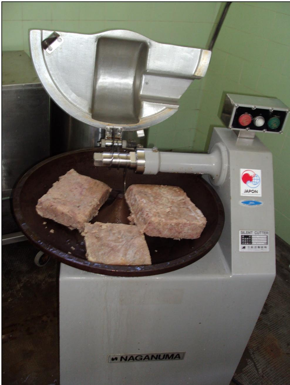
**Figura 20:** Silent Cutter Naganuma NHY-12 con bloques de pulpa de pescado.
