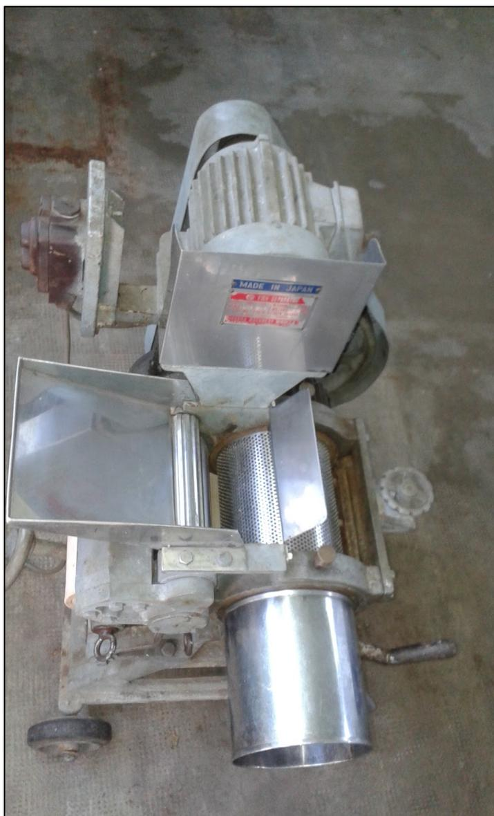
**Figura 11:** Máquina despulpadora Fish Separator Yanagiya small type.
