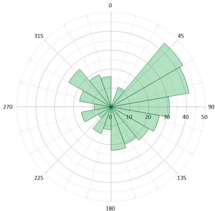
Fig. 22 Rosa de los vientos con las direcciones principales del fracturamiento del área, tanto por análisis de fotolectura como luego de realizado el filtrado sobre la dirección establecida como deformación dúctil 1:20000 del ortomosaico.
