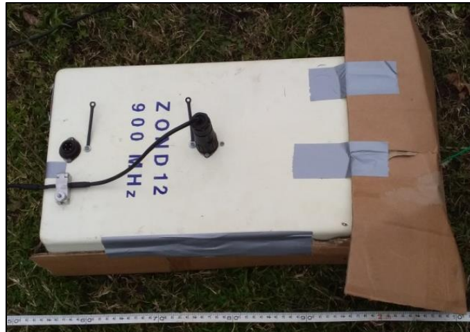
Figura 8. Imagen de antena 900 MHz y cable que conecta a computadora.
