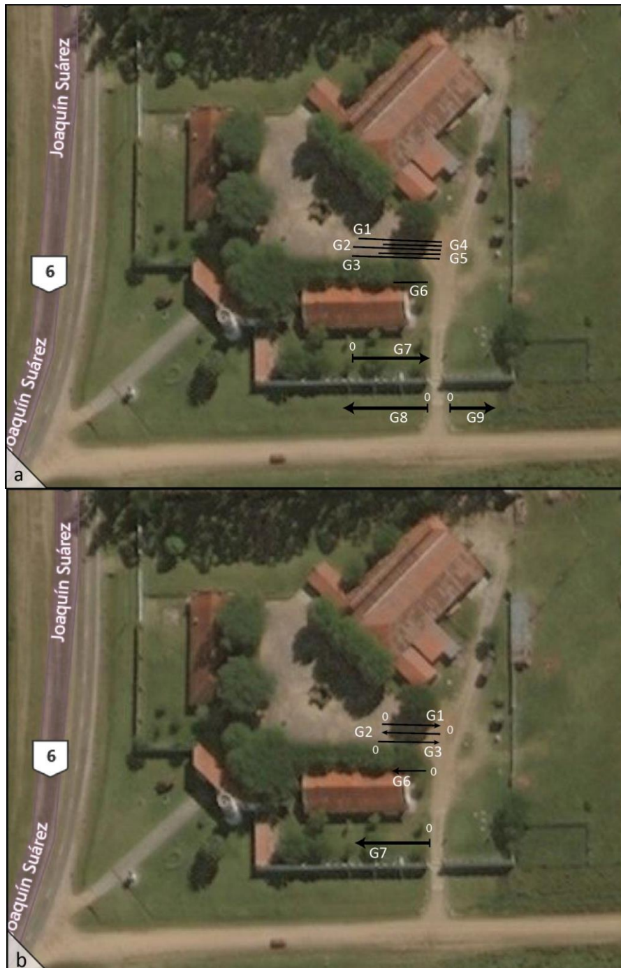
Figura 11. Ubicación de las líneas de medida con Georadar. Antena con frecuencia central de 500 MHz (a) y 900 MHz (b). En a, las líneas de G1 a G5 se encuentran cada 0,7 m aprox. En b las líneas G10, G11 Y G12 presentan una distancia entre ellas de aproximadamente 1,5 m.
