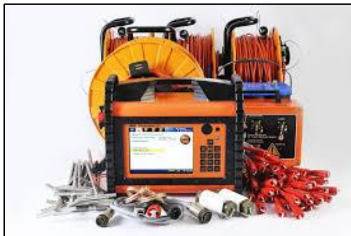
Figura 6. Imagen del equipo básico del Terrameter LS (ABEM, A., 2012) con los rodetes de cables de corriente al fondo, la consola de comando al frente, los electrodos a la izquierda y los conectores a la derecha.
