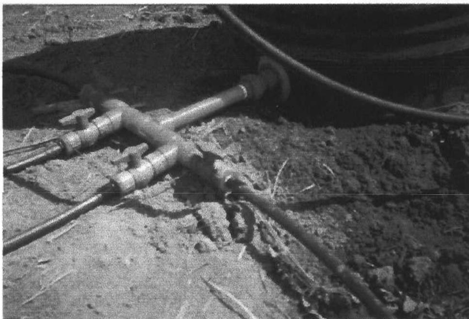
FOTO N°2: Cabezal del dispositivo de goteo.
