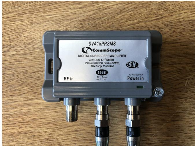
Figura 7.5: Amplificador CommScope sva15prsms.
