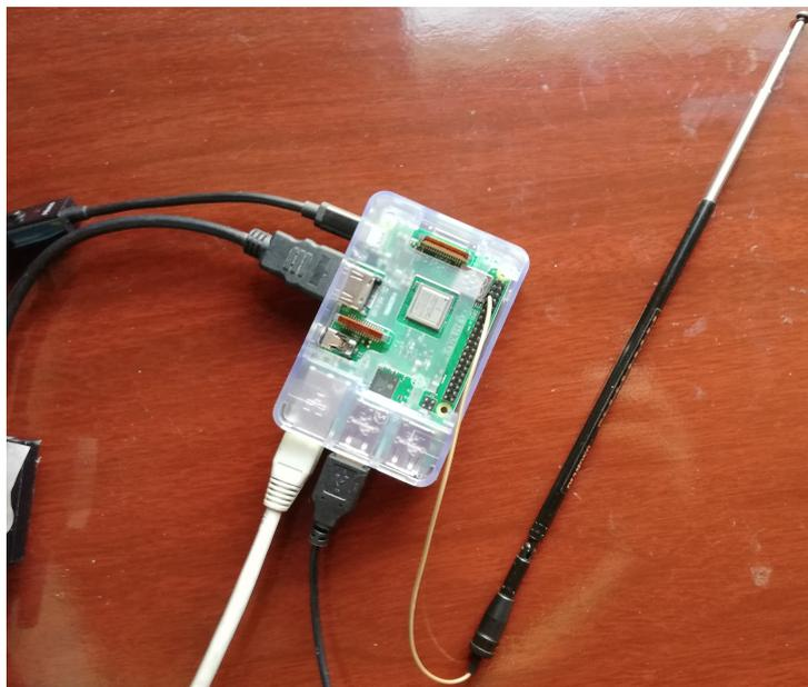
Figura 10.1: Configuración de Raspberry Pi para transmisión.
