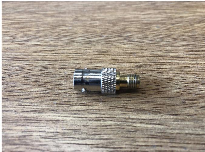
Figura 7.4: Adaptador BNC a SMA.
