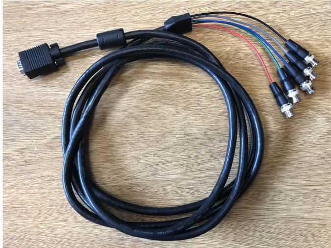
Figura 7.3: Adaptador VGA a BNC.
