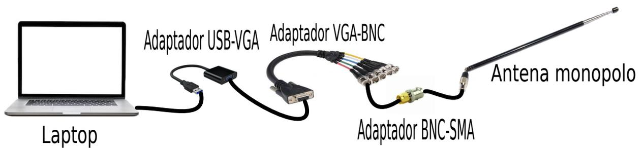
Figura 7.7: Diagrama de conexión.
