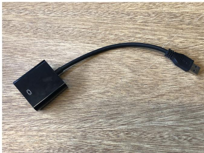
Figura 7.2: Adaptador USB-VGA.
