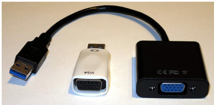
Figura 6.2: Adaptador USB 3.0 a VGA basados en el chip Fresco Logic FL2000.
