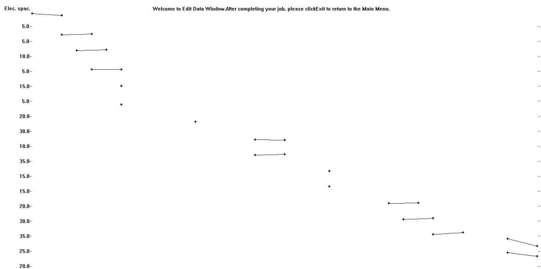
Figura 46. Datos crudos de resistividad aparente tomados en la tomografía Pinar Norte con el arreglo Wenner-Schlumberger.
