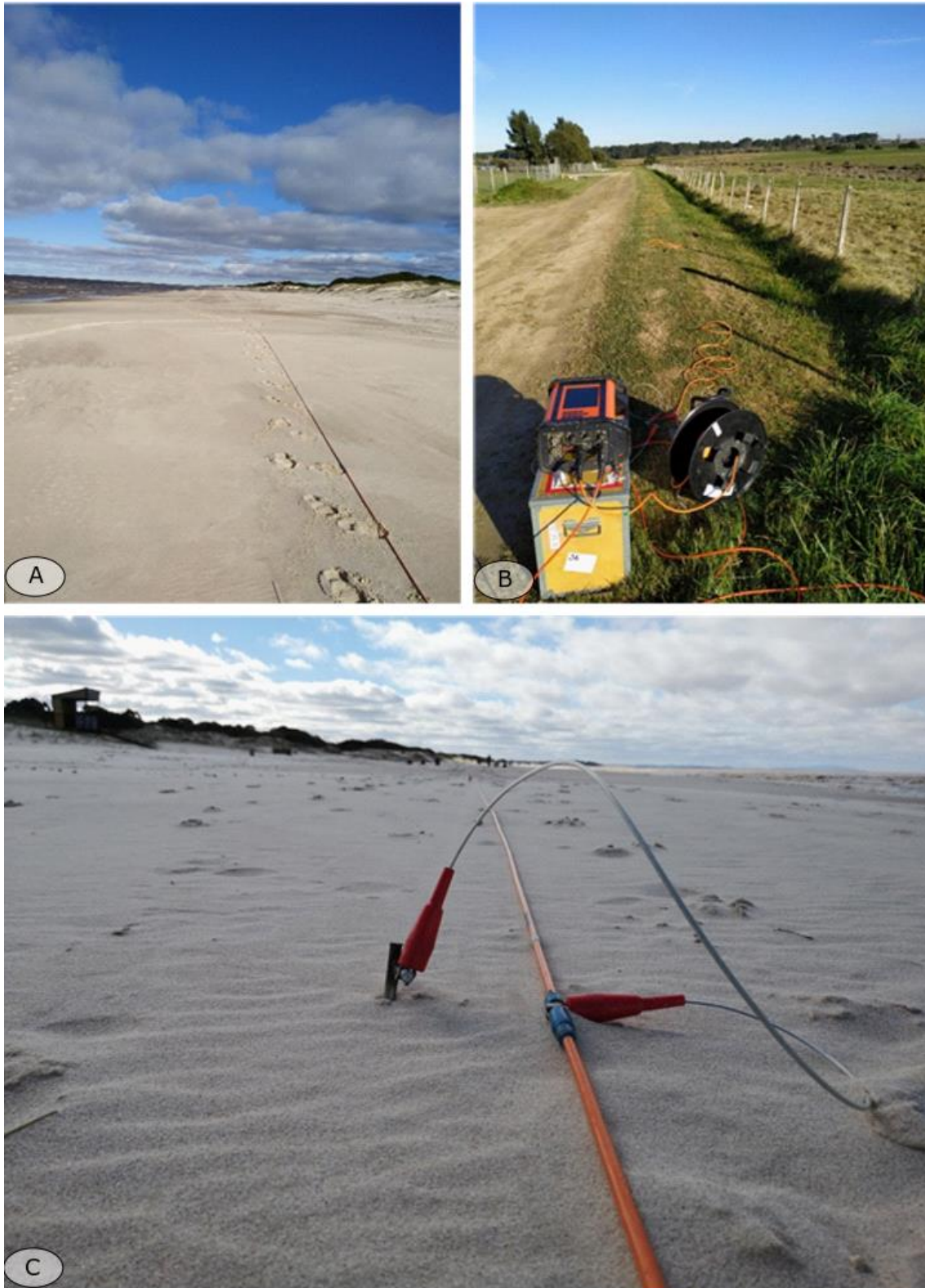
Figura 24. A) Cable multielectrónico en la línea de la playa; B) Consola Terrameter Ls junto a rollo porta cable; C) Electrodo enterrado en contacto con cable multielectrónico, mediante cable conector.
