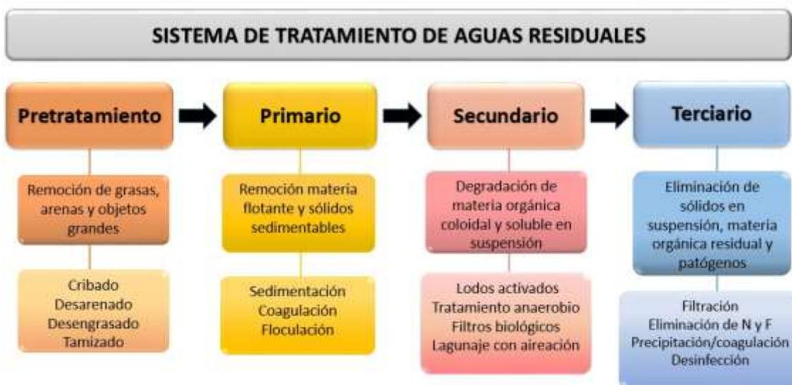
**Figura 1.** Esquema general de sistemas de tratamientos de aguas residuales. Los cuadros superiores indican el nombre, luego el proceso que ocurre en cada paso, en los de abajo se describe el mecanismo por el cual se realiza el tratamiento correspondiente a cada etapa. Figura modificada de Sonune, A. y Ghate, R. (2004).
