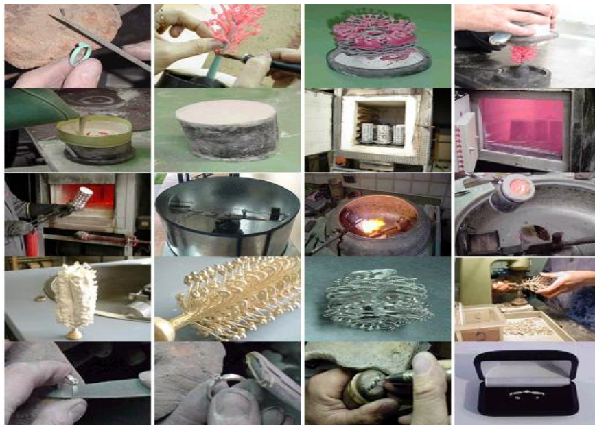
Ilustraciones que muestran el proceso completo de fabricación de un anillo.
