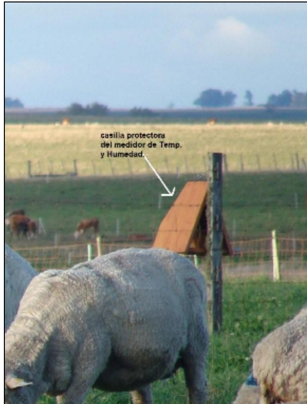
Foto 6: casilla protectora de medidor de temperatura y humedad
