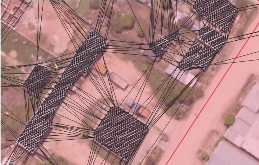
Imagen 33: Triangulación de Delaunay de los puntos clasificados como construcción
