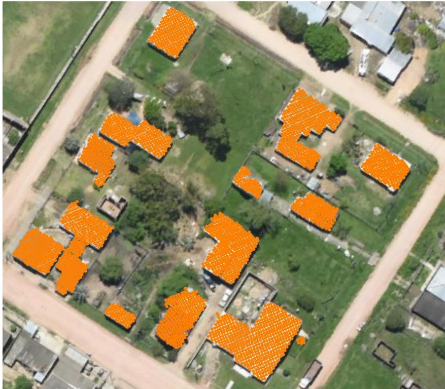
Imagen 60: Puntos clasificados como construcción vistos sobre ortomosaico –
