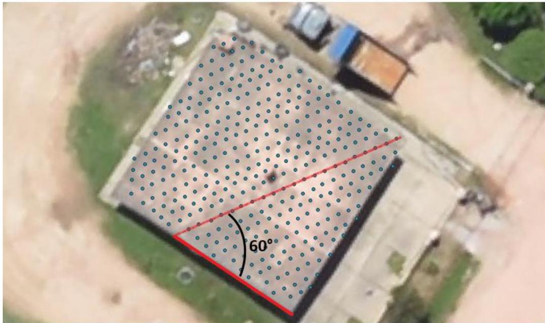
Imagen 49: Orientación de las líneas de barrido del láser respecto a las construcciones – Fuente: elaboración propia
