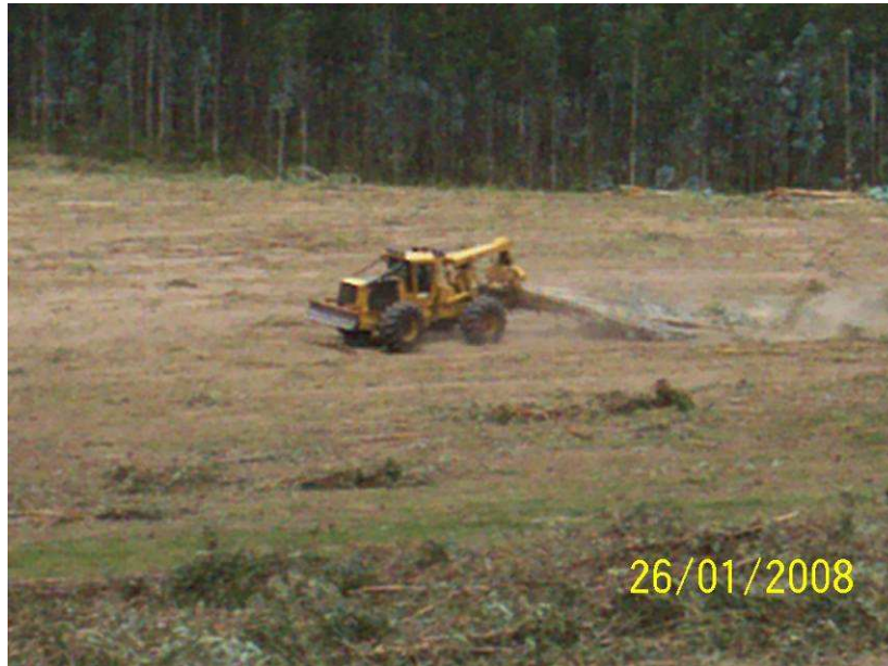
Skidder arrastrando troncos desde la zona de cosecha hacia la cancha de procesado a borde de camino.
