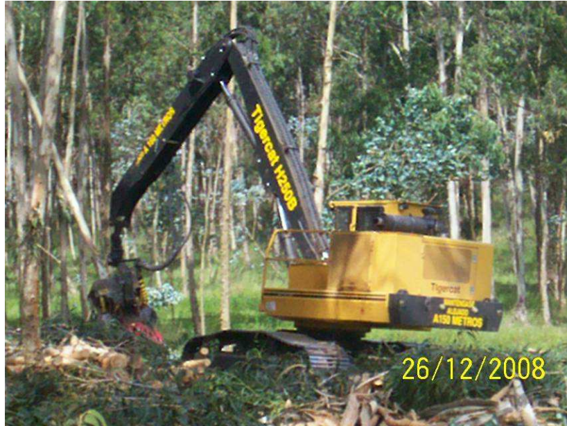
Procesadora de madera de bandas, trabajando como “Harvester”, a “pie de monte”, en sistema de cosecha mecanizado estudiado.
