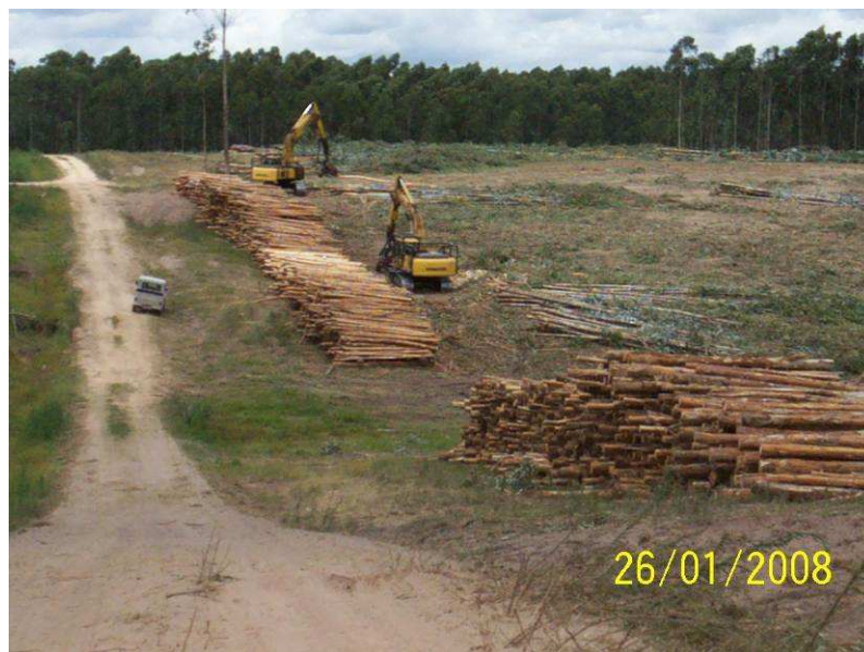
Procesadoras de madera trabajando en cancha de procesado de madera en sistema de cosecha mecanizado estudiado. La procesadora de abajo está parada, escuchando indicaciones técnicas del ayudante de cosecha. Fotografía de: Eduardo Méndez.
