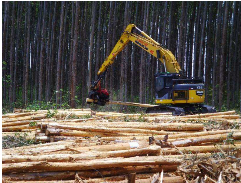
Procesadora de madera de bandas, trabajando como “Harvester”, a “pie de monte”, en sistema de cosecha mecanizado del Sud Este del Estado de Bahía en Brasil.
