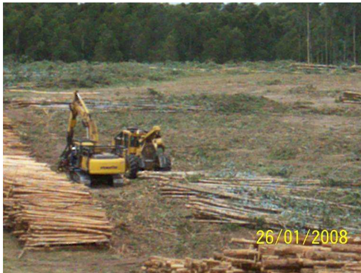
El skidder acaba de dejarle un “manejo” de troncos a la procesadora para que descortece, troce y apile en la cancha de procesado de madera a borde de camino.
