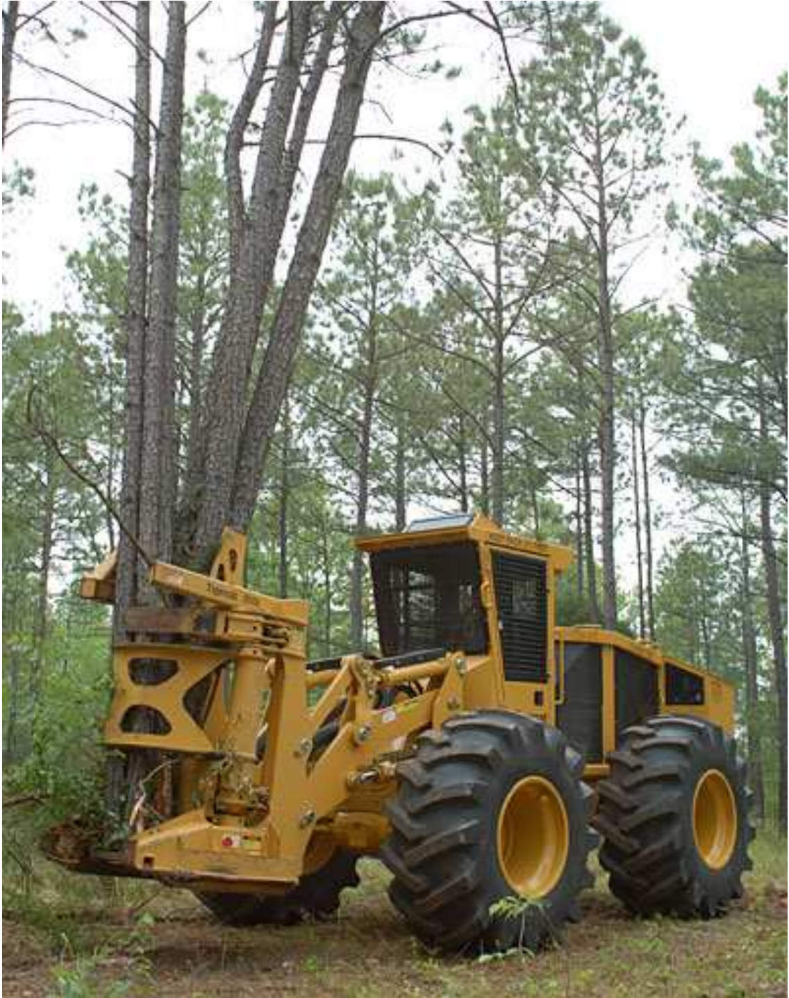
Feller buncher en acción. Proceso de “toma” y “acumulación” del árbol. Fuente: Tigercat (2009)
