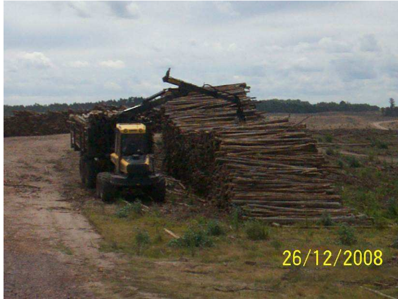
Forwarder apilando la madera que trajo del campo, a borde de camino. Fotografía de: Eduardo Méndez.
