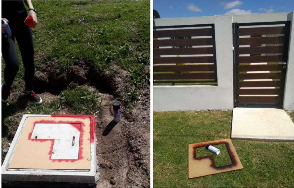
(a) Esquina marcada con pintura en aerosol. (b) Punto en esquina no pintada, losa de entrada a casa particular.
