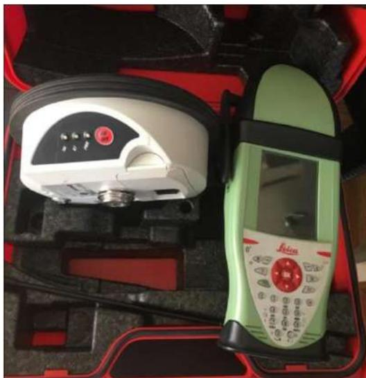
Figura 9: Equipo GNSS *Leica Viva GS8* utilizado en los relevamientos. Fuente [25].
