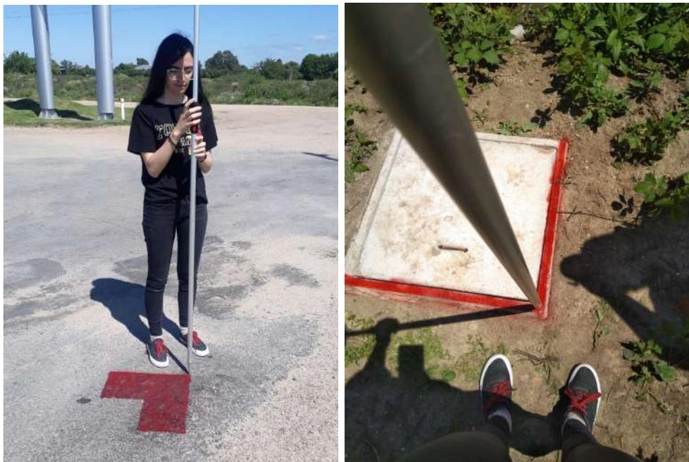
(a) Relevamiento GNSS de marca hecha con stencil. (b) Relevamiento GNSS de esquina de tapa marcada con pintura en aerosol.
