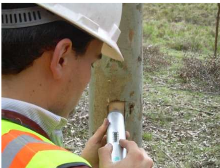
Figura 7 Toma de datos con Pilodyn
