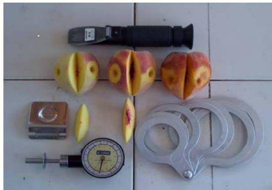
Figura 7: En la parte superior refractómetro de mano, en la parte inferior izquierda penetrómetro de mano.
