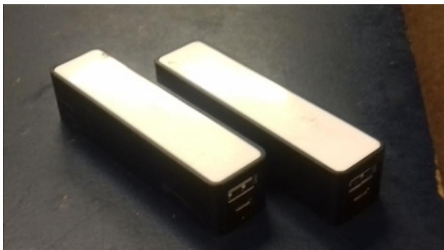
Figura 3.2: Power banks utilizados para alimentar los motores y le microcontrolador.
