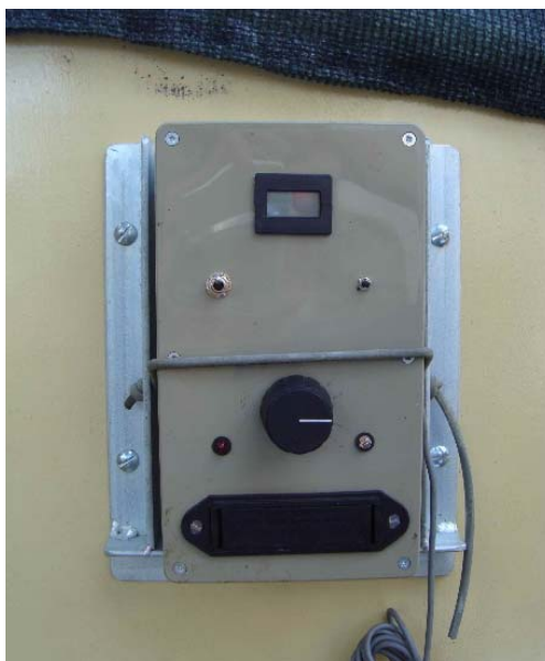
Figura 4: Agitómetro colocado en una de las paredes del cajón de aislamiento.
