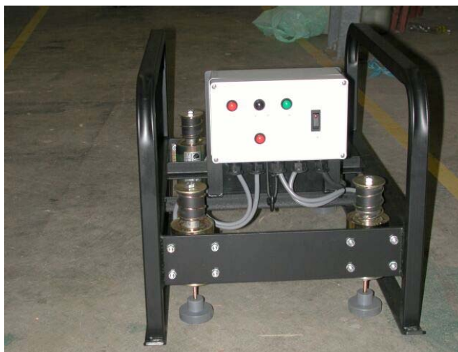
Figura 5: Unidad de calibración u oveja electrónica vista de frente (tomado de Blache y Ferguson, 2005b).
