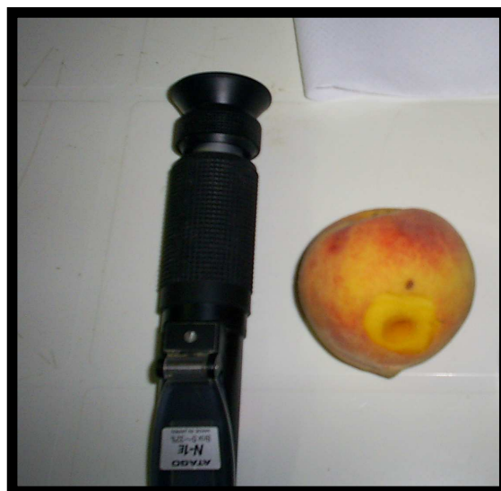
Figura No. 18. Vista del refractómetro de mano utilizado y de la zona del fruto en que se extrajo la muestra de jugo para la determinación
