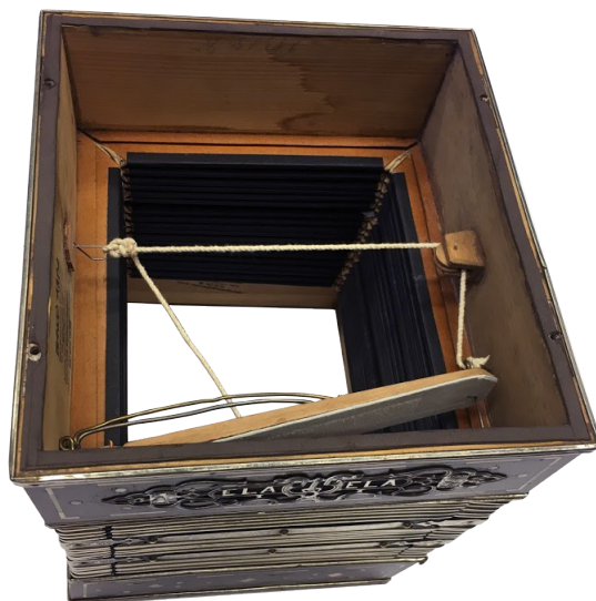
Figura 1.5: Sistema de polea que acciona la escotilla de liberación aire.
