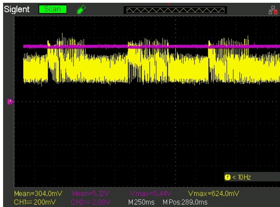
Figura 7.2: Sistema con volumen máximo ( velocity = 127 , CH1 = V_{R_{sense}} y CH2 = V_{ext} ).
