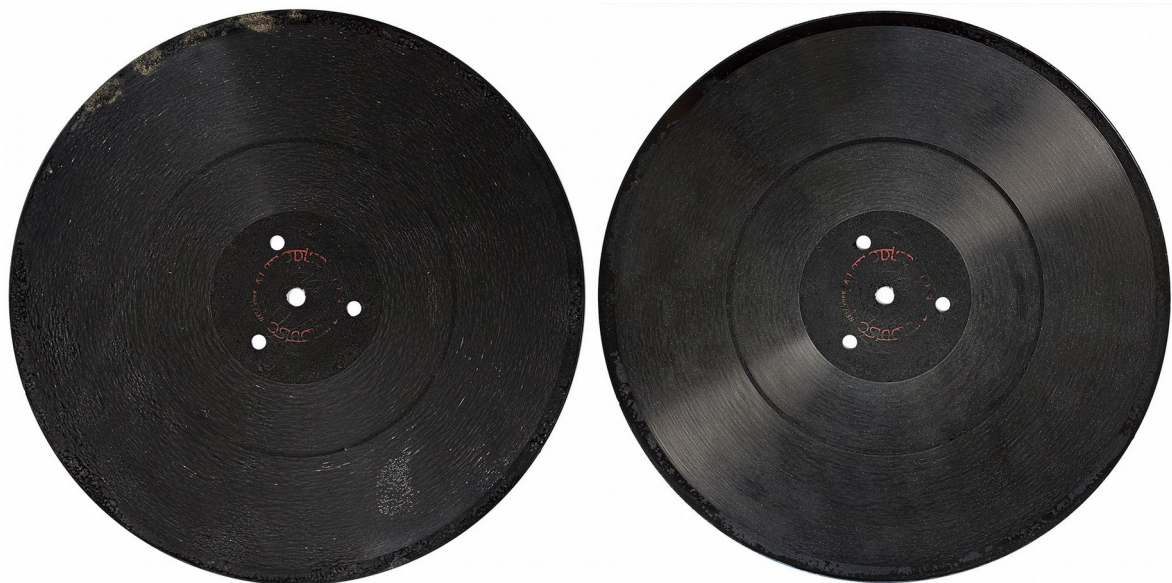
Figura 5: Disco de acetato de base metálica de 25 cm de diámetro utilizado por Lauro Ayestarán para grabar a Amalia de la Vega en 1949, antes (izquierda) y después (derecha) de la limpieza.
