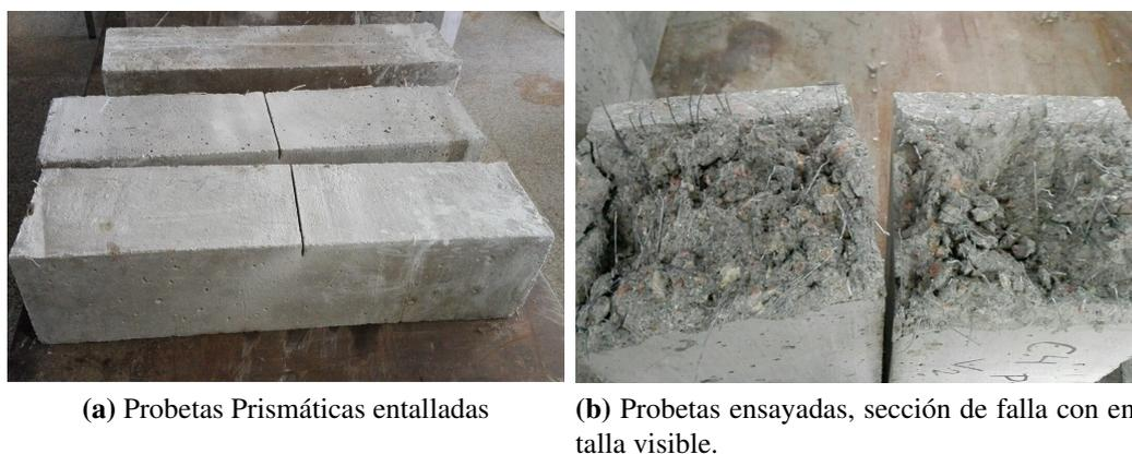
**Figura 4.6:** Probetas prismáticas para ensayo EN 14651.
