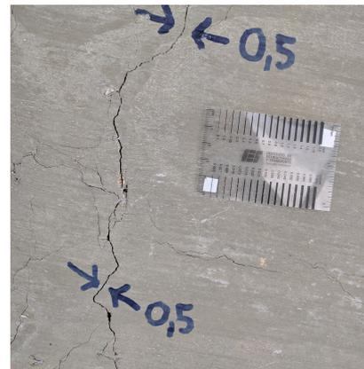
(b) Fisuras en escalón de carga intermedio.
