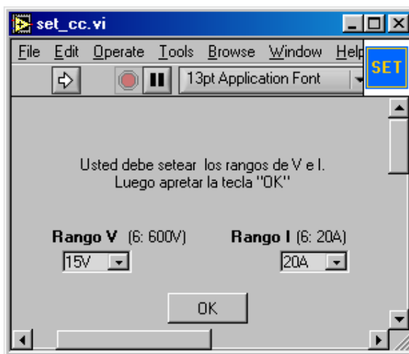
Fig. 5-8 Menú en el cuál se setean los rangos de tensión y corriente en el ensayo de cortocircuito.
