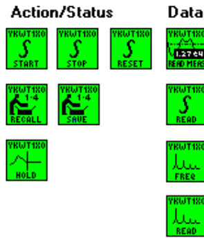
Fig. 4-13 Iconos de acciones, estatus y tratamiento de datos del vatímetro YOKOGAWA TW110
