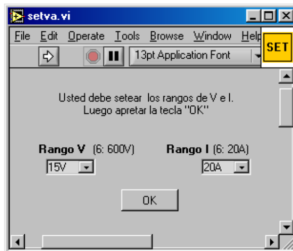
Fig. 3-7. Menú que aparece en la ejecución del programa para el seteo del rango de tensión y corriente.
