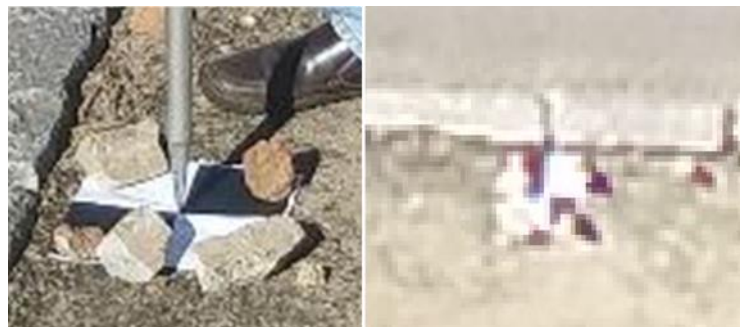
Ilustración 32: Forma de colocación de marca de punto de control a la izquierda y vista de la misma marca en las imágenes captadas por Drone. Fuente propia.
