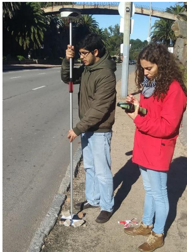
Ilustración 27: Relevamiento de punto de control con GPS. Fuente propia.
