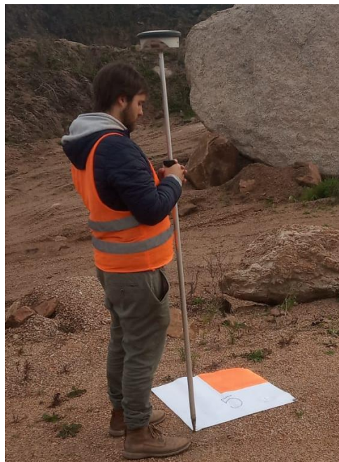
Ilustración 44: Punto de apoyo. Fuente propia.
