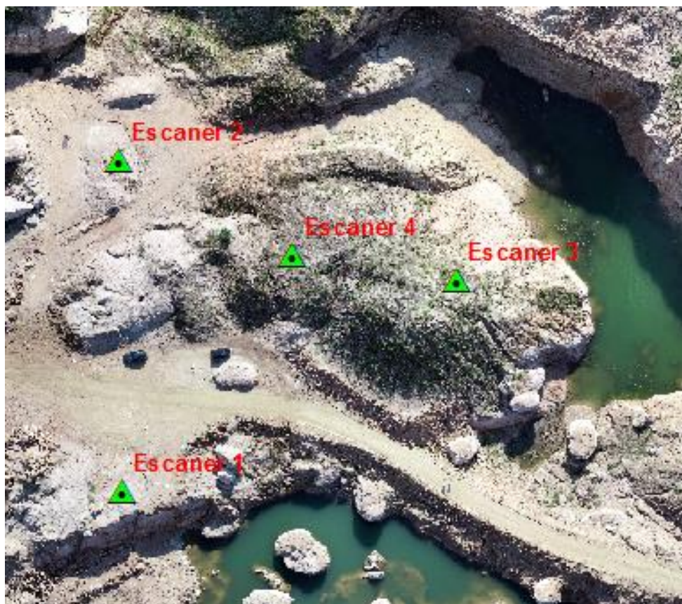
Ilustración 48: Ubicación de la Estación Escáner en campo. Fuente propia.
