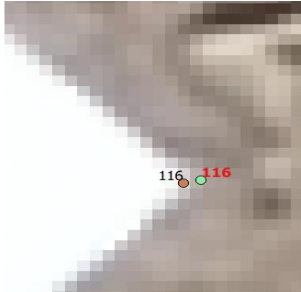
Ilustración 91: B: Punto de control: medido con GNSS (color verde), medido en el ortomosaico (color marrón). Fuente Qgis.
