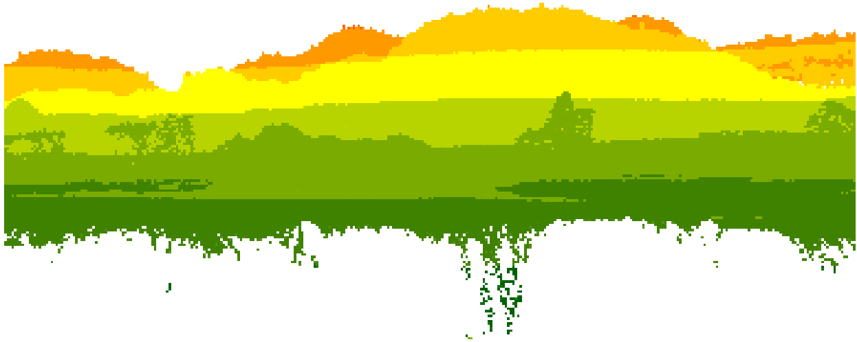
Ilustración 107: Vista lateral de la nube de puntos donde se ven los outliers. Fuente ArcGIS
