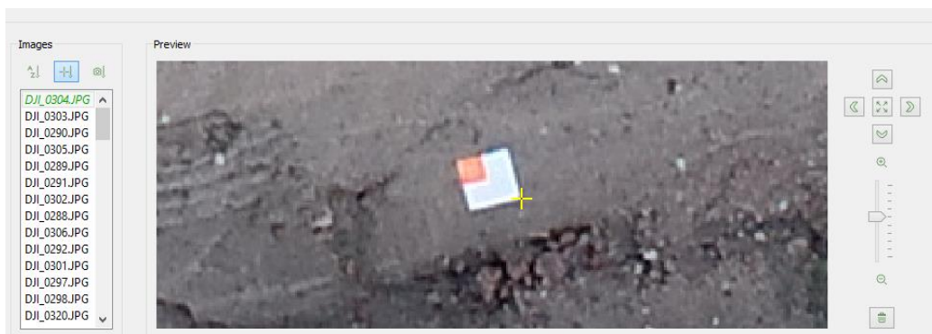
Ilustración 60: Detalle de puntero sobre marca en una de las imágenes. Fuente Pix4D.
