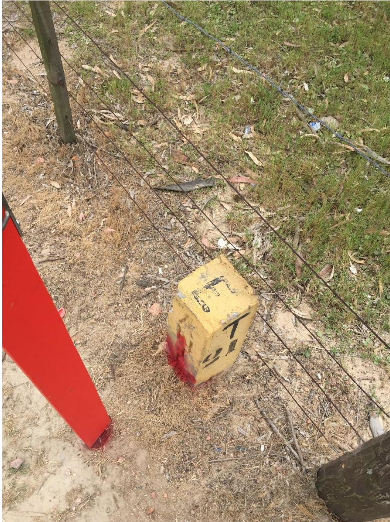
Imagen 20 – Materialización y marcado de los puntos
