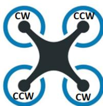
Figura D.10: Sentido del giro de las hélices del dron<sup>7</sup>.
