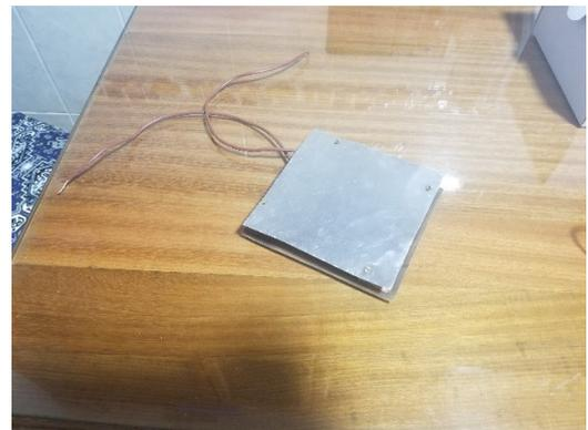
Figura B.6: Baliza realizada con resistencias y placas conductoras.
