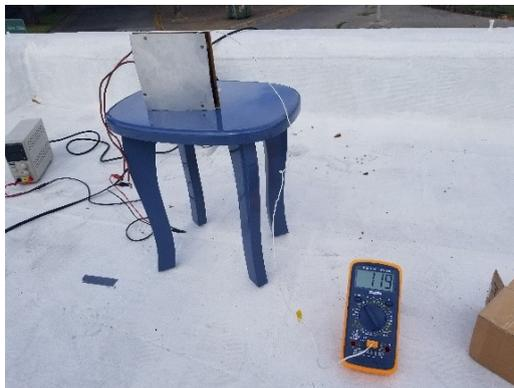
Figura B.8: Setup del sistema para el testeo de la baliza de resistencias.
