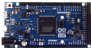
Figura 6.4: Placa Arduino DUE
