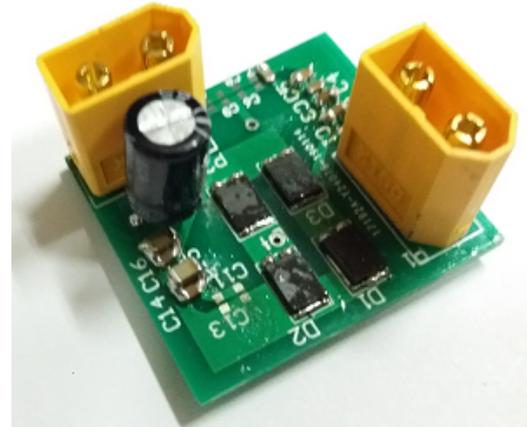
Figura 5.12: Placa terminada del módulo de recepción de energía
