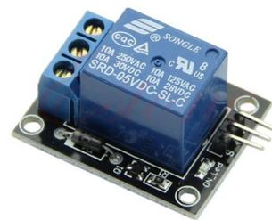
Figura 7.7: Relé que energiza al módulo de recarga.
