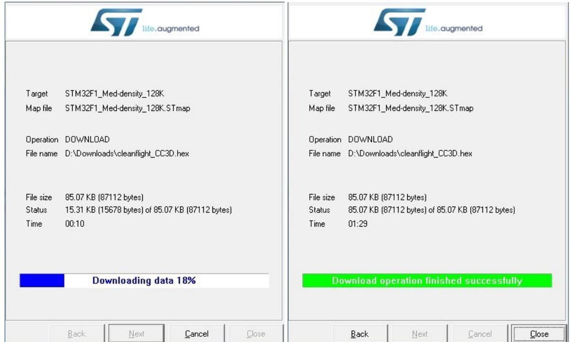
Finalizado este proceso reiniciar el CC3D, desconectar el convertor serie-USB y el mainport; conectar el CC3D al PC mediante un cable USB-miniUSB y ejecutar el software CleanFlight” verificando que reconozca el dispositivo.
