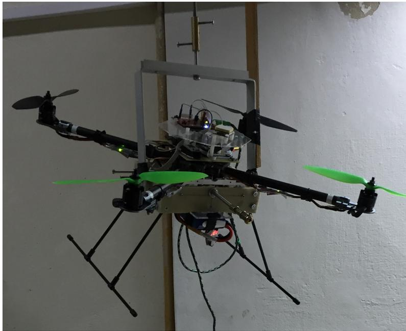
Figura 16.1: Cuadricóptero en el dispositivo de suspensión.
