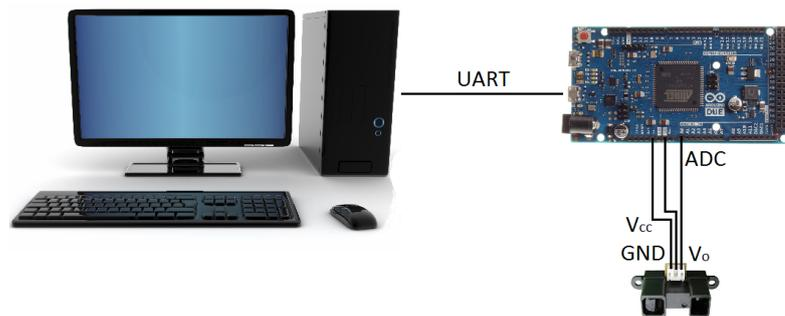
Figura 6.3: Diagrama de conexiones.
