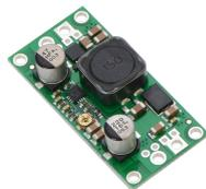
Figura 3.5: Regulador de voltaje ajustable 4-12V S18V20ALV.
