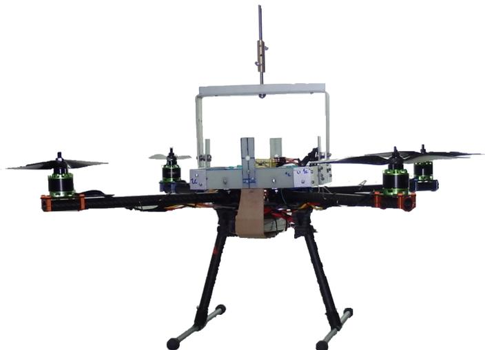
Figura 7.2: Cuadricóptero acoplado al *Canetígiro*.
