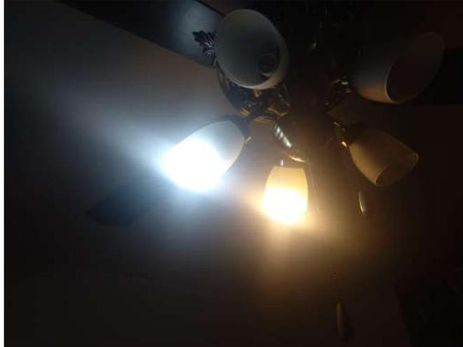
Figura 2.2: Efecto de *blooming*. Los dos focos de luz emiten una señal suficientemente intensa como para saturar los sensels.
