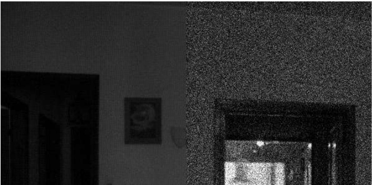
Figura 4.5: Ejemplo de un caso de estimación errónea del ruido de las imágenes. A la izquierda, un parche con un nivel de ruido razonable ( $a = 0,0004, b = 0,00013$ ). A la derecha, un parche para el cual se estimó una distribución de ruido muy alta ( $a = 0,0628, b = 0$ ).
