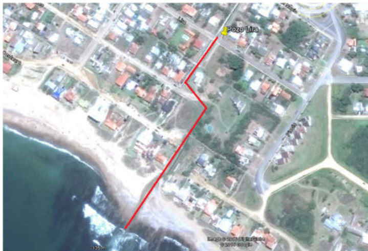
Figura 6. Aliviadero Estación de Bombeo Lira.
