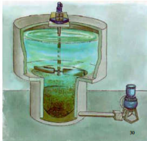
Figura 10. Ejemplo de desarenador de vórtice. Fuente: Notas curso Tratamiento de efluentes, Facultad de Ingeniería, Udelar.
