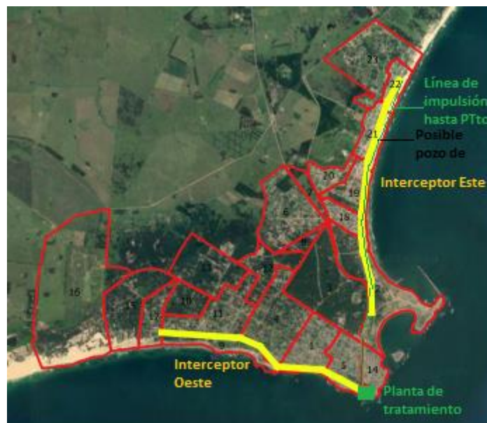
Figura 38. Imagen ilustrativa de configuración de interceptores con planta de tratamiento y línea de impulsión.
