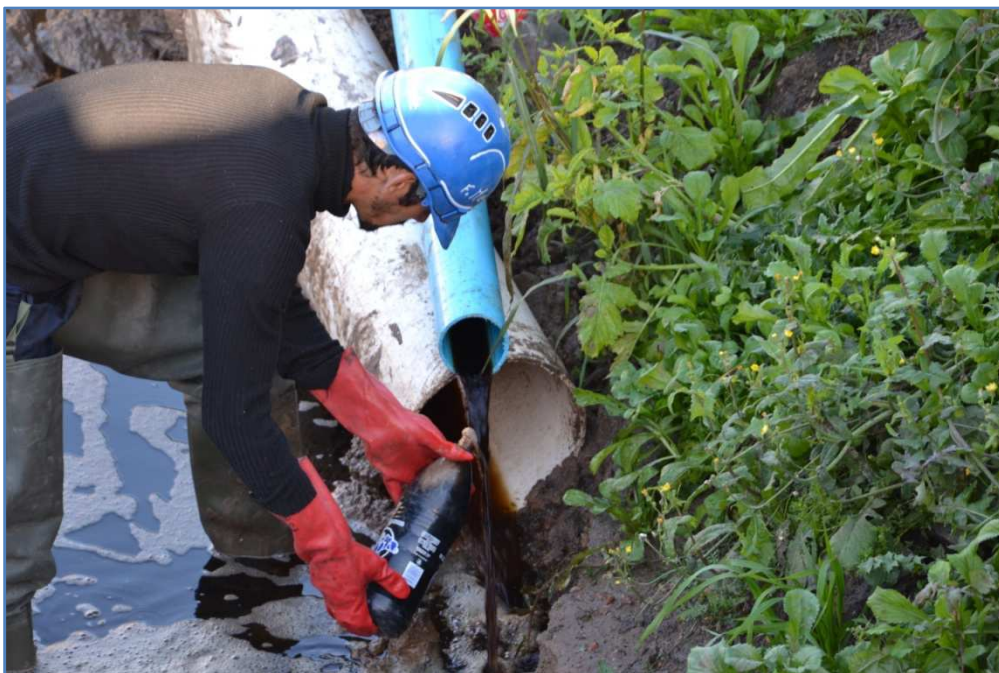
Fotografía 3-3 Funcionario de Espina tomando muestras del lixiviado proveniente de usinas 6,7 y 8(celdas A y B) con envase de refresco
